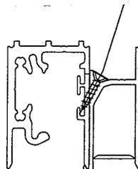
4. До начала монтажа разместить каретки и стопор внутри направляющей. Стекло ставится под направляющей (защита кромки стекла!). При подъеме стекла отверстия в держателе-каретке должны совпасть с отверстиями в стекле. Стекло закрепляется. Для регулировки высоты: ослабить верхний держатель, вращая нижний держатель-эксцентрик стекло поднимается или опускается на нужную высоту, снова закрепить верхний держатель. Запас регулировки составляет примерно 1,5мм.
