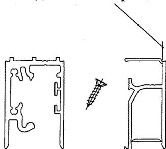
Соединение профилей посредством шурупа 4,2x16 с конической шляпкой
