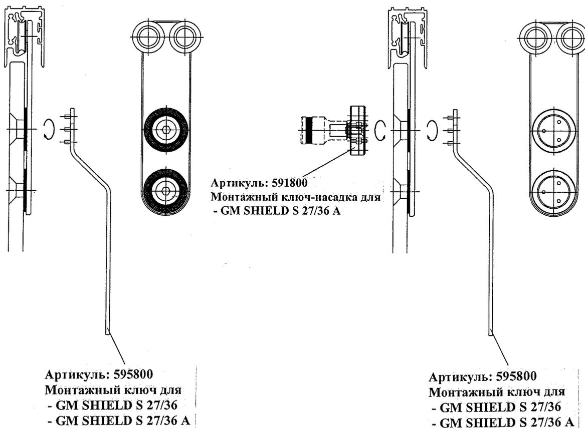
5. Стопер ( 1-левый, 1-правый) передвигается на нужную позицию и фиксируется шурупом.
