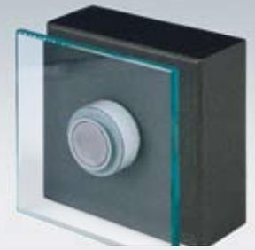
GM PICO KING® wurde von Glas Marte Bregenz speziell für die einfache und rationelle Befestigung im Innenbereich entwickelt. Zur Montage sämtlicher Plattenmaterialien (8 – 12 mm Stärke) können beliebige Senkkopfschrauben mit einem Durchmesser von 6 mm verwendet werden.
